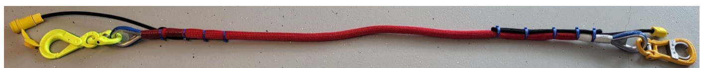
Abb. 4: AM_NH90_SKG mit Connex SKT-13-8 direkt am der Kausche eingebaut. Hier Feuerlöschleinen TLME_25_2_BW.
