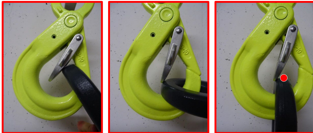
Abb.: 22 – 24: Missbrauch! Wird die Hakenöffnung direkt nach Einführen des schwarzen Beschlags geschlossen, kann die Sicherungsfalle nicht korrekt verriegelt werden!
