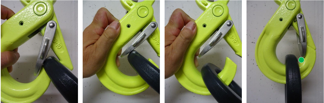
Abb. 18 – 21: Haken öffnen, Beschlag/Kausche über die Hakenspitze ziehen. Den schwarzen Beschlag bei geöffnetem Haken bis zum Hakengrund herabziehen. Er sitzt erst richtig, wenn sich auch die 2. Sicherungsfalle vollständig schliessen lässt.
