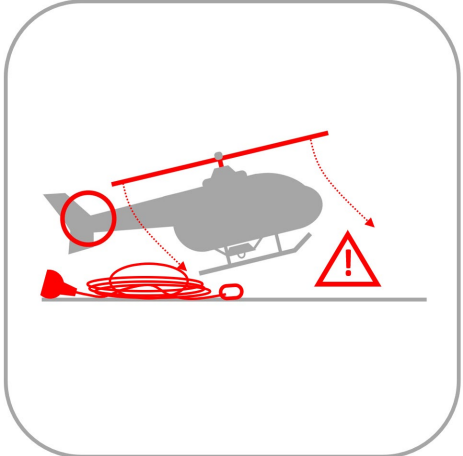
DANGER : ARRONDI OU ATTERRISSAGE AU-DESSUS DES CORDES
