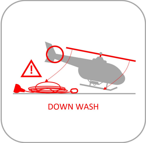
DANGER : EFFET DOWN WASH ET ROTOR DE QUEUE
