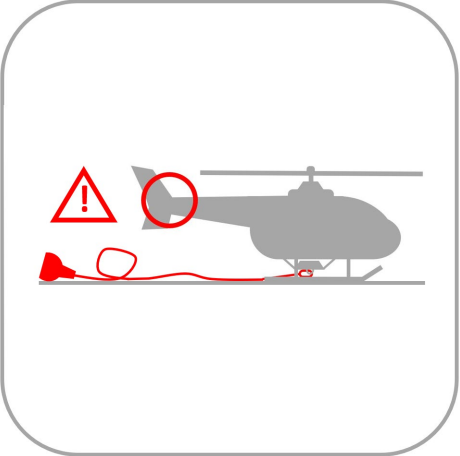
DANGER : ROTOR DE QUEUE TROP PRÈS DES BOUCLES DE LA CORDE
