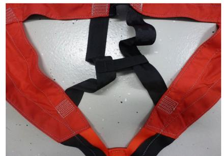
Fig. 11: e chiudere il rinforzo con la velcro
