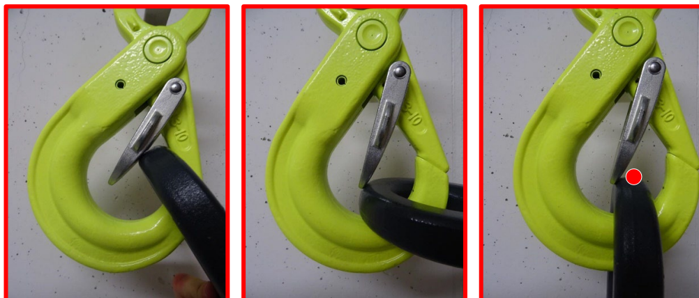
Abb.: 15 – 17: Missbrauch! Wird die Hakenöffnung direkt nach Einführen des schwarzen Beschlags geschlossen, kann die Sicherungsfalle nicht korrekt verriegelt werden!
