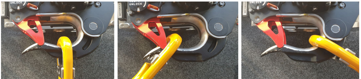
Abb.: 18 – 20: Hängen Sie das AM_NH90_SKG13 in den Primärlasthaken und prüfen Sie, ob es sich frei bewegen kann, ohne die Funktion des Primärlasthakens zu beeinträchtigen.
