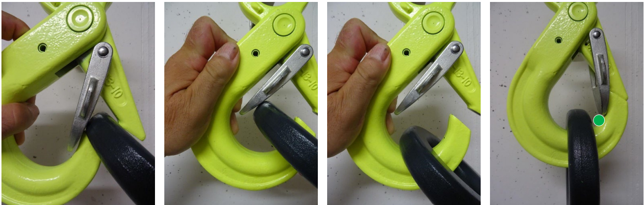
Abb. 11 – 14: Haken öffnen, Beschlag/Kausche über die Hakenspitze ziehen. Den schwarzen Beschlag bei geöffnetem Haken bis zum Hakengrund herabziehen. Er sitzt erst richtig, wenn sich auch die 2. Sicherungsfalle vollständig schliessen lässt.
