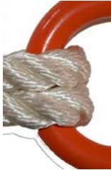
Abb: Dämpferseil 2 x 12 mm auf Ovalring AW 13 (∅ 13mm) = Anwendung kritisch
