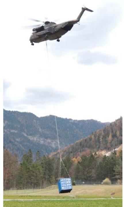
CH-53 delle forze armate con fune di trasporto TLM da 90 kN
