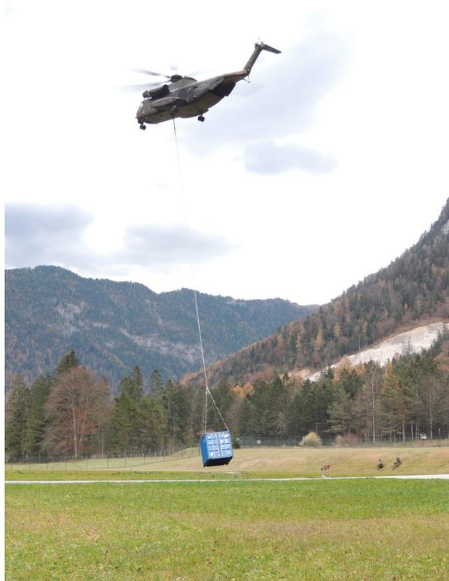
Fig. 1: CH-53 delle forze aeree con fune TLM\_90\_30 (WLL 90 kN).
