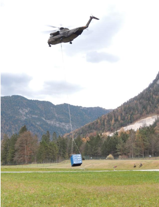
Fig. 1: CH-53 des forces aériennes, équipé de corde TLM\_90\_30 (WLL 90 kN).
