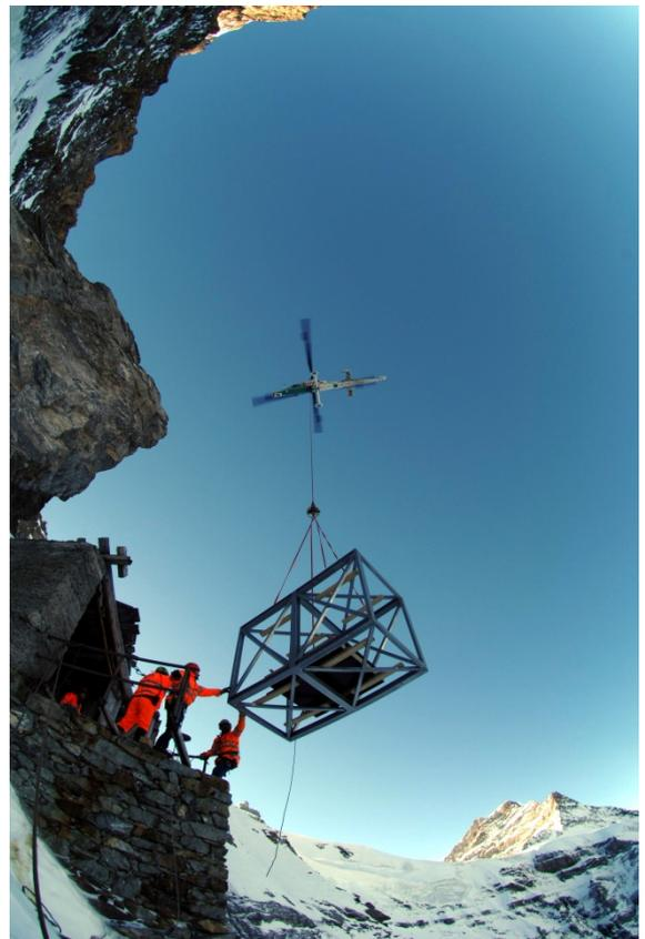
Fig. 4: KAMAN K-1200 "K-MAX" avec TLP\_55\_30 (WLL 30 kN).
