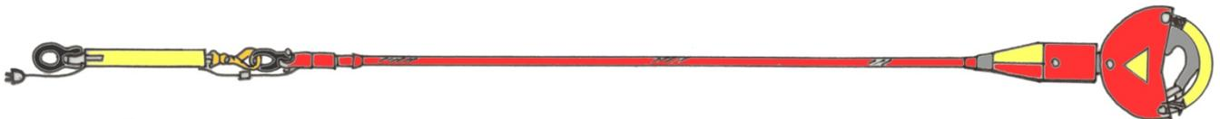
Exemple: élingue électrique modèle TLL, TLP ou TLPME; avec maille de tête, amortisseur, crochet de sécurité, maille de levage, corde, Goggel avec compensateur de torsion (interne) et crochet secondaire
