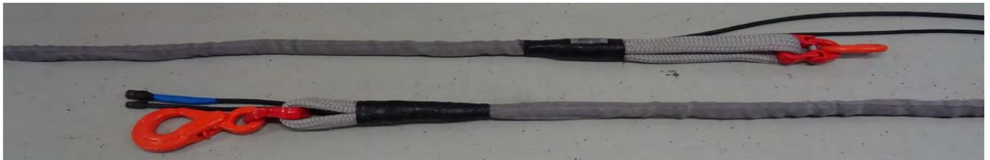
Fig. sopra: Fune TLME\_76\_20 per l'estinzione degli incendi da 76 kN di WLL, per l'elicottero CH-53. L'anima è permanentemente protetta contro la sporcizia.
