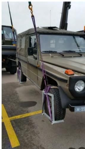
Puch delle forze armate svizzere con dispositivo per il sollevamento di veicoli
