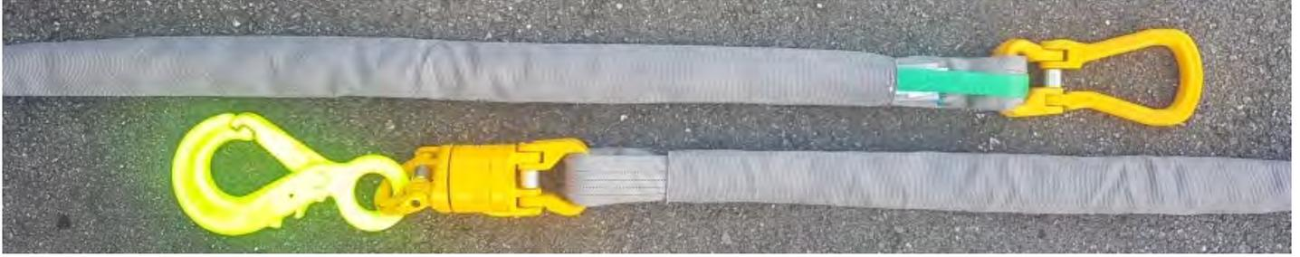
Fig.: La "classica" delle funi tattiche. Qui sopra con un gancio di sicurezza OBK di un colore limone brillante: la Gunnebo ha lanciato la gamma dei suoi prodotti in classe 8 secondo la norma EN 1677, ma in seguito, pezzo a pezzo, l'ha completata o sostituita col la classe 10.
