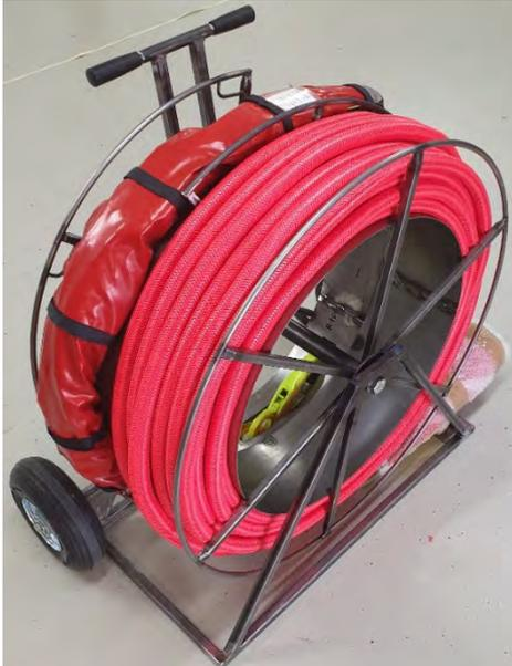
Fig. a sinistra: Corda TLP\_40\_50 con ammortizzatore su tamburo con ruote fuoristrada.
