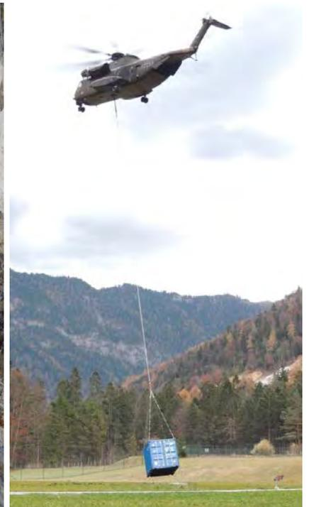
CH-53 delle forze armate svizzere con fune di trasporto TLM da 90 kN
