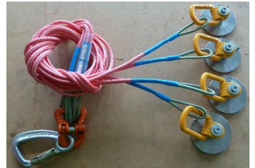
Fig. a sinistra: Sonda ACTOS del TROPOS/Leibniz Institut. Fune da 8 mm di  $\varnothing$  e 170 m di lunghezza. Fig. al centro: ADS di precisione per sonda di misurazione del Bundesanstalt für Geowissenschaften und Rohstoffe (Istituto federale tedesco per le geoscienze e le materie prime) Fig. a destra: fune speciale con 4 punti d'imbracatura per il trasporto di un radome (struttura per proteggere un radar).
