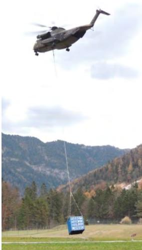
CH-53 delle forze armate svizzere con fune di trasporto TLM da 90 kN
